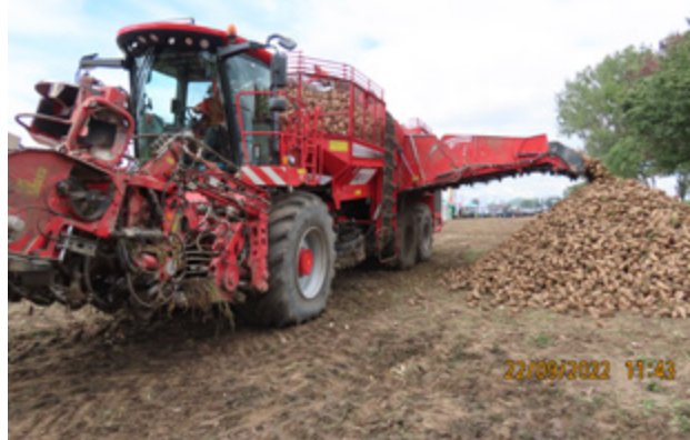
Pryzma w przekroju poprzecznym powinna mieć kształt litery A, dlatego należy ją uformować przenośnikiem wyładawczym kombajnu. W celu ograniczenia uszkodzeń korzeni przenośnik należy opuścić możliwie nisko. (fot. J. Przybył)
