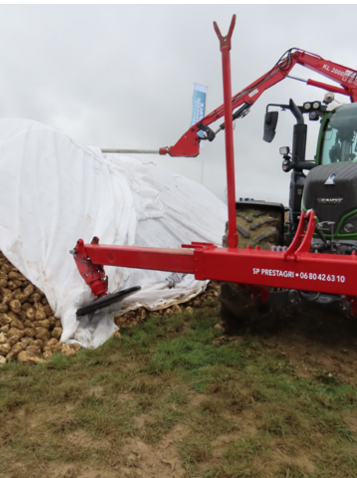
Urządzenie Klünder KL 2000 do rozwijania i zwijania włókniny z przyzmy buraczanych. Rozwiniętą włókniną wciska się między buraki specjalnym krojem tarczowym zamontowanym czołowo na tym samym ciągniku. (fot. J. Przybył)
